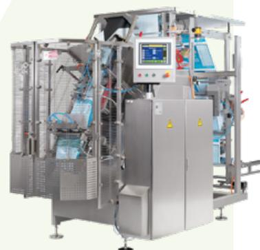
*Diseñada para el llenado cuidadoso de productos frágiles: la inno-tech REVO con tubo de llenado inclinado.*
