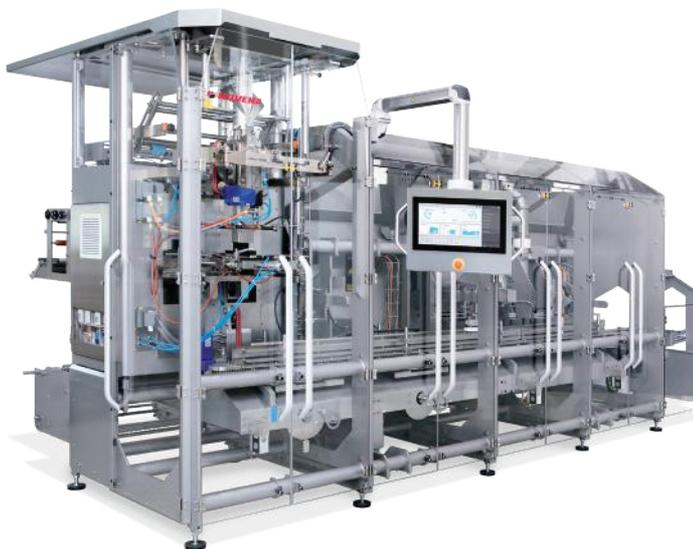
**Sistema integrado de máquina envasadora vertical y módulos posteriores para el diseño de la parte superior de la bolsa y el cierre.**
