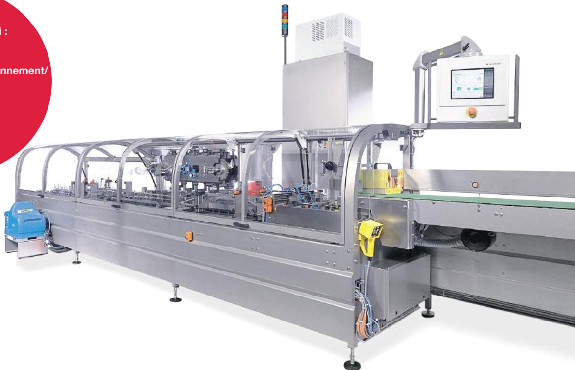
Encartonneuses robustes pour la mise en forme et le remplissage de boîtes pliantes. Traitement fiable de découpes et de matériaux de boîtes pliantes exigeants, également avec redressement pneumatique. Systèmes d'acheminement adaptés à votre application.
