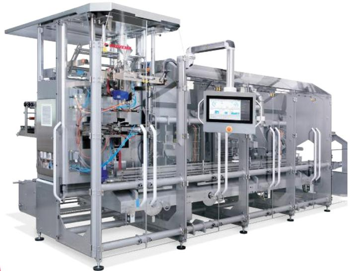
**Système intégré comprenant une machine pour sachets tubulaires et des modules en aval pour la réalisation du haut du sachet et de la fermeture du sachet.**
