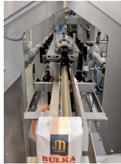
Vertikale Beutelproduktion mit anschließender Kopfformung im ROVEMA SBS - für kompakte, luftarme Beutel mit gleichmäßigem Füllgrad.
